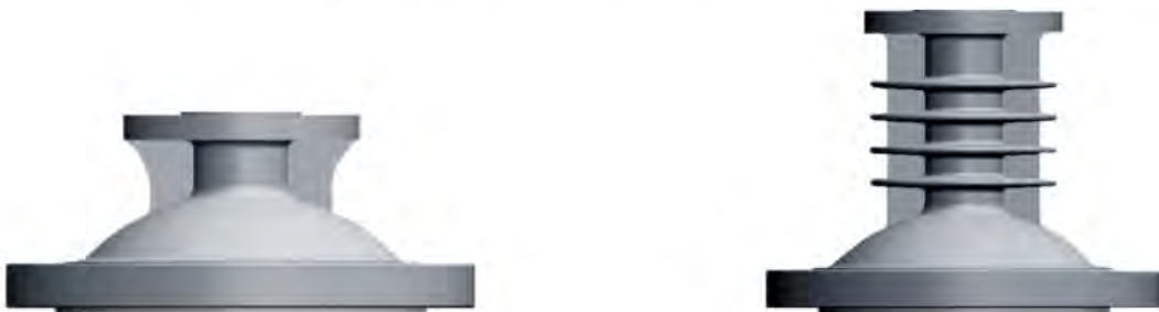
a) 常温型阀盖 -29℃~250℃ b) 散热型阀盖 > 250℃
