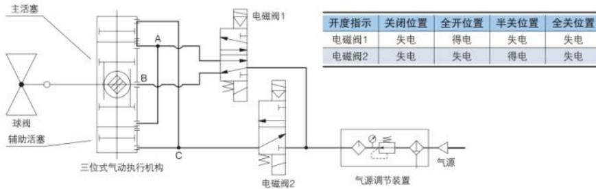
图36 齿轮齿条式一段开两段关气动球阀电气控制原理图
