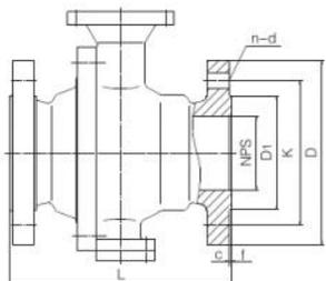
图19 ASME B16.5 突面法兰连接尺寸示意图
