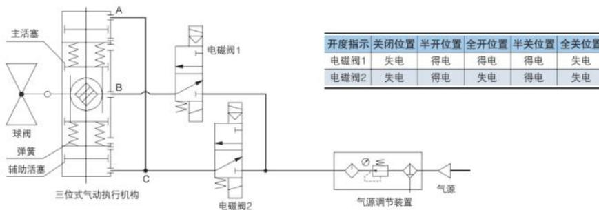
图38 齿轮齿条式单作用(弹簧复位)两段开两段关气动球阀电气控制原理图
