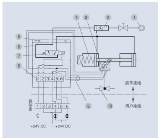
图33 杠杆拔叉式单作用(弹簧复位)执行机构隔爆系统单电控原理图
