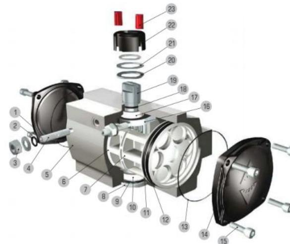
图2-1 双作用齿轮齿条式气动执行机构典型结构 (代号：ZS51)
