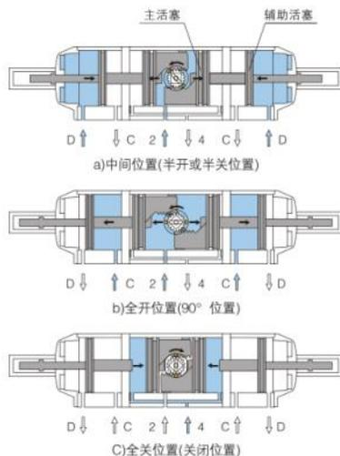
图34 齿轮齿条式双作用二段开二段关气动球阀工作过程
