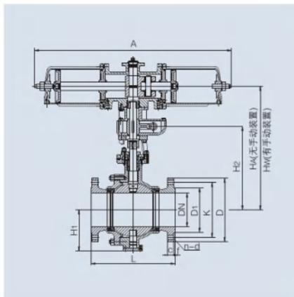
图22 TY-Q6wF7Y型气动带手动固定球阀(二体式)
