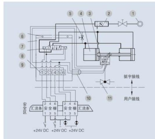
图30 杠杆拔叉式气动执行机构本安系统双电控原理图
