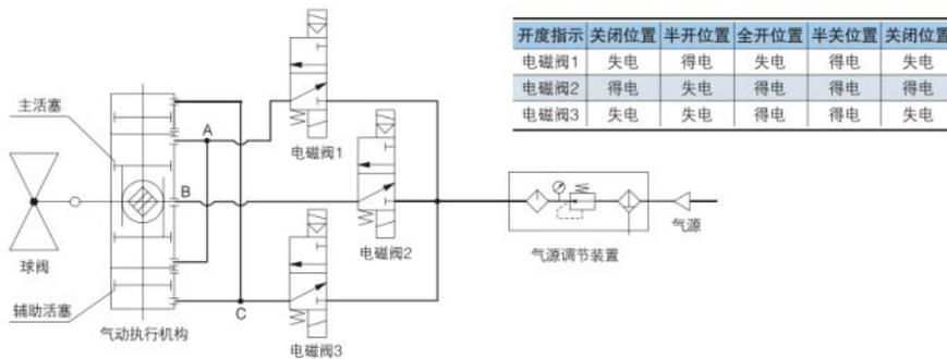
图37 齿轮齿条式两段开两段关气动球阀电气控制原理图
