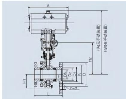
图17 TY-Q6wF7Y型气动带手动固定球阀
