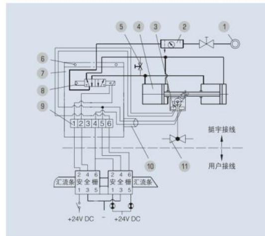
图31 杠杆拔叉式气动执行机构本安系统单电控原理图
