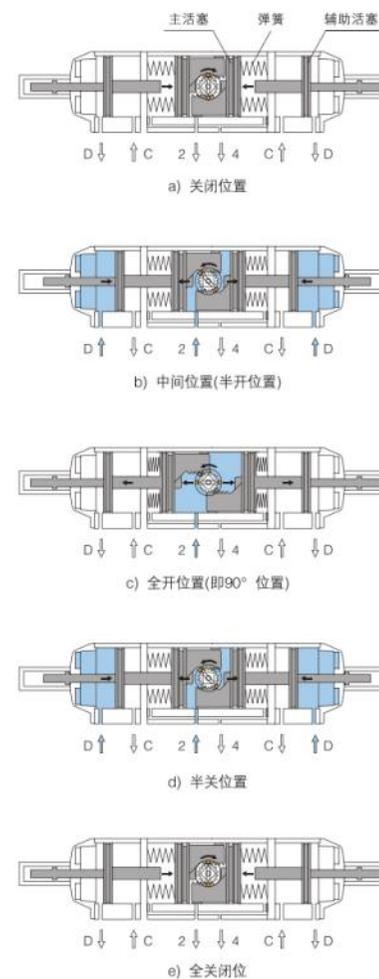
图35 齿轮齿条式单作用两段开两段关气动球阀工作过程
