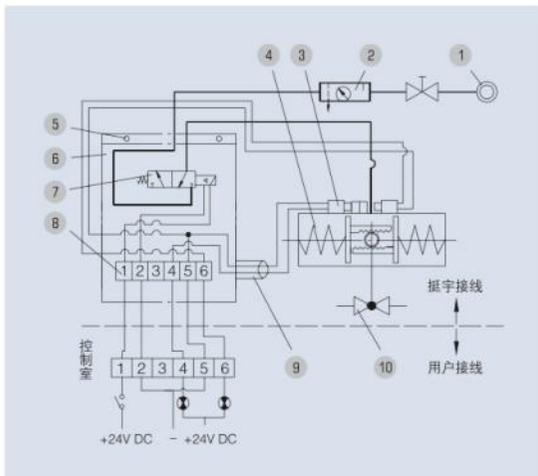
图32 齿轮齿条式单作用(弹簧复位)执行机构隔爆系统单电控原理图
