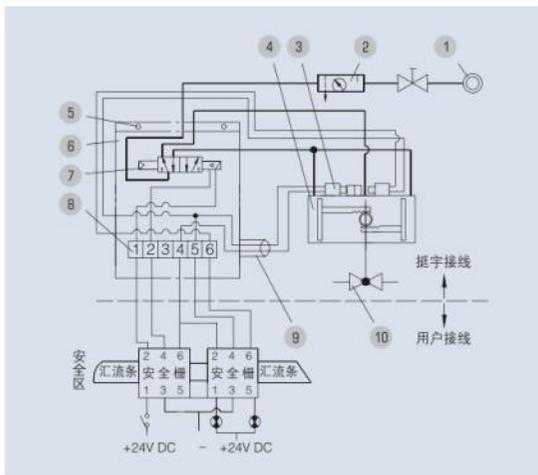
图29 齿轮齿条式气动执行机构本安系统单电控原理图
