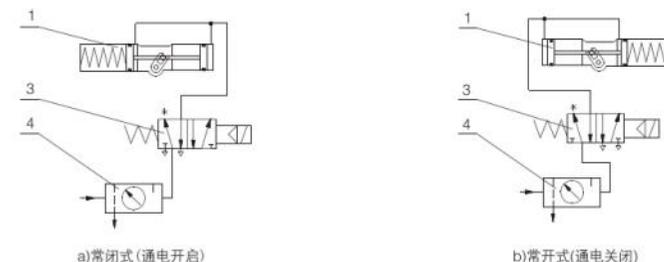
① 气动执行机构 ② 平衡阀 ③ 二位三通电磁阀 ④ 气源调节装置
