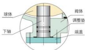
图8 防静电结构
