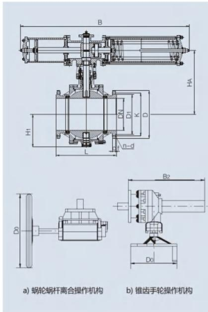
图23 TY-Q6kF7Y/Q6bF7Y 气动固定球阀(三体式)
