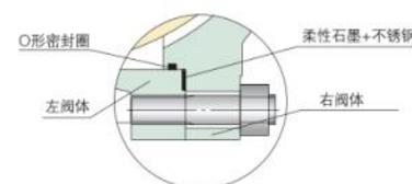
b) 中法兰密封的防火结构
