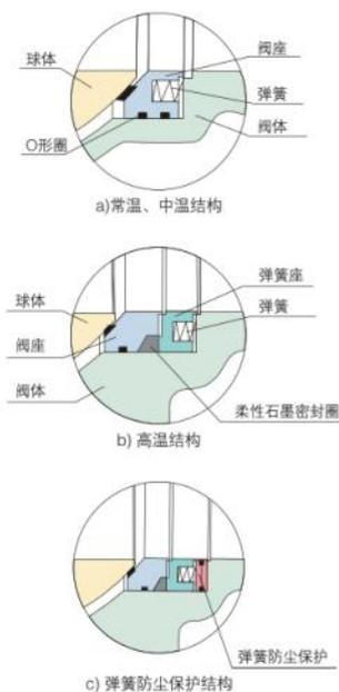
图13 硬密封球阀密封座结构
