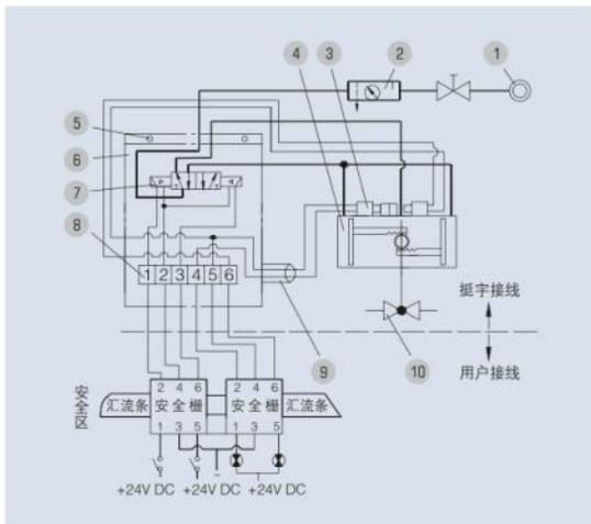
图28 齿轮齿条式气动执行机构本安系统双电控原理图
